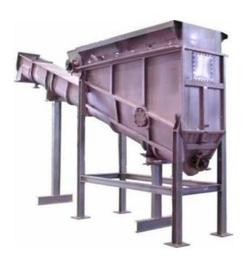
Bei Behältern zur Gewinnung der Sinkfraktion erfolgt der Materialaustrag in der Regel mittels einer überdimensionierten Austragschnecke. Als Option werden diese Behälter mit einer Beheizung ausgeführt und außen isoliert. In dieser Sonderausführung werden die PET-Flakes bereits vorgewärmt und mit Natronlauge und Reinigungsmitteln benetzt. Diese Behälter werden aus Edelstahl 1.4571 gefertigt.
