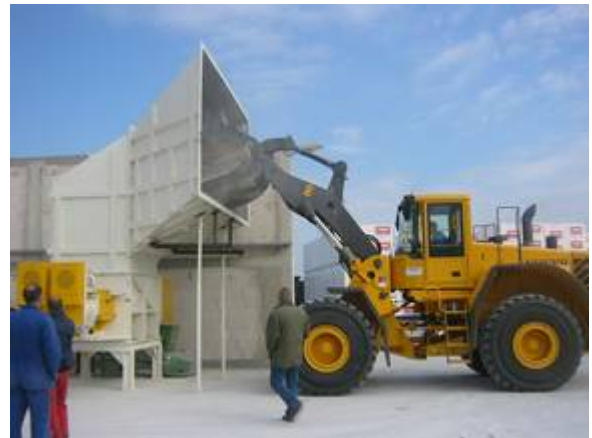
Bild: Schneckenbrecher Typ SB 560/2 (für die Zerkleinerung von Kalksandsteinen)
