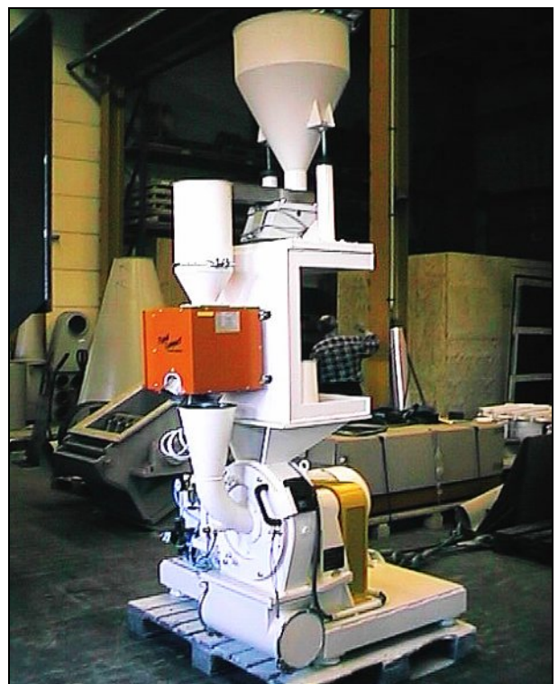
Feinmahlmühle mit induktivem Metallabscheider ↓
