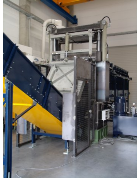
Guillotineschere GS 1500/1000, Beschickung durch Pufferband mit Anpreßband, Abführung durch Steilband.
