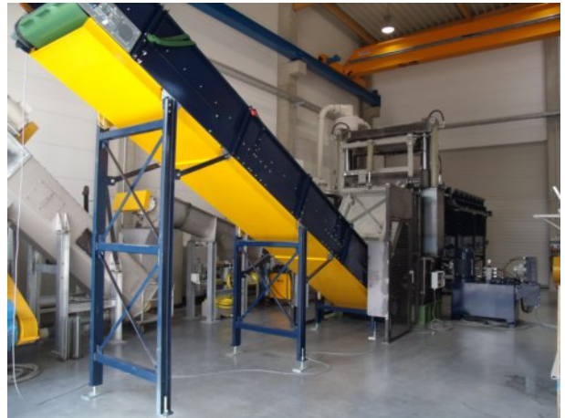
Guillotineschere GS 1500/1000, Beschickung durch Pufferband mit Anpreßband, Abführung durch Steilband.
