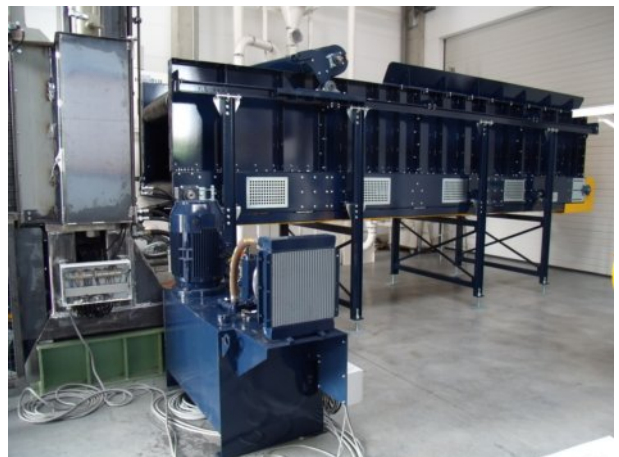
Guillotineschere GS 1500/1000, Beschickung durch Pufferband mit Anpreßband, Abführung durch Steilband.
